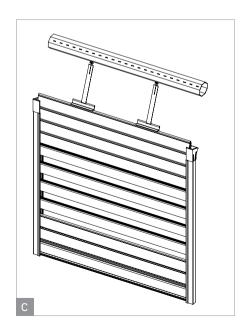
Inserire l'estremità dell'attacco al telo con molla all'interno delle asole preesistenti sul rullo.
