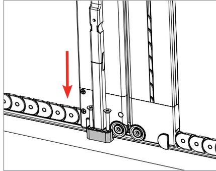
**10** Portare al centro la barramaniglia e posizionare il riscontro inferiore per il paletto centrale, fissandolo a terra. **N.B. distanziare il riscontro di qualche millimetro rispetto alla guida inferiore.**
