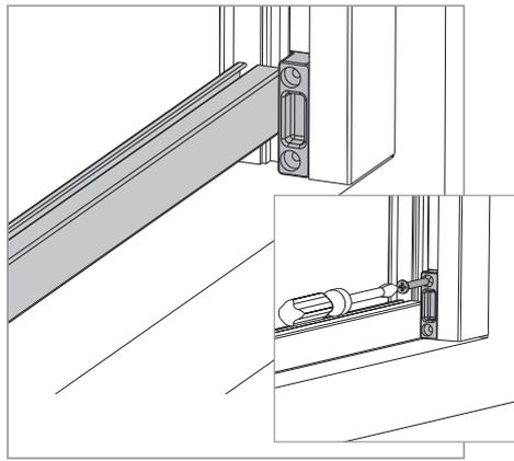
**11** Appoggiare a terra la guida bassa, inserendola nel profilo di riscontro. Avvitare il fermo guida.
