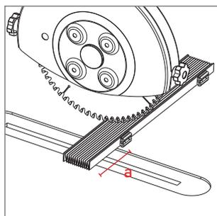
**1** In base alla misura finita del vano, tagliare la rete sottraendo alla misura ulteriori 24 mm. **Attenzione: Tagliare la rete nella parte superiore (a).**
