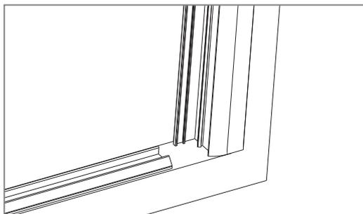
**13** Dopo aver fissato il telaio al vano, inserire la guida inferiore. Premere in maniera decisa la guida inferiore al pavimento.
