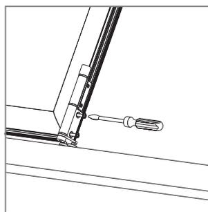
**17** Montare la cerniera sulla seconda anta, serrando le apposite viti. Ripetere l'operazione sulla parte inferiore della seconda anta.
