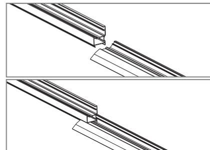
**3** Inserire la guida superiore nel profilo superiore del telaio.
