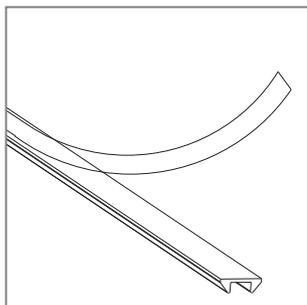
**12** Staccare il nastro di protezione del biadesivo dalla guida inferiore.
