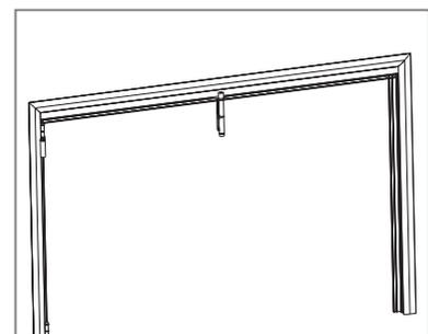
**11** Il telaio sarà quindi montato e sarà costituito dalla guida superiore e dai profili laterali.
