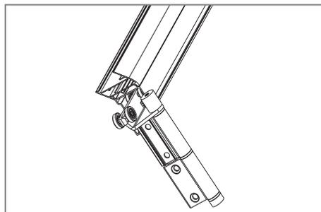
**5** Inserire i carrelli lungo la guida superiore.
