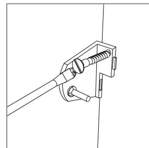
**4** Fissare il primo elemento del supporto tendicatena.
