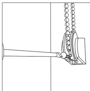
**7** Fissare al vano il secondo elemento supporto tendicatena.
