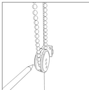
**3** Portare in tensione la catena e posizionare il tendicatena. Segnare il punto di fissaggio del supporto tendicatena.
