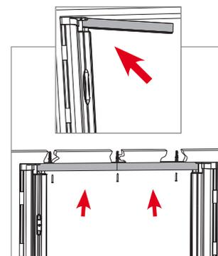
**7** Posizionare i compensatori e procedere con il fissaggio.
