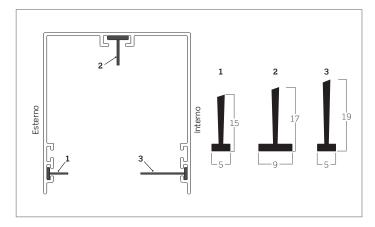
Inserire gli spazzolini nella guida superiore. ATTENZIONE! Lo spazzolino 1 va inserito nella guida sul lato che va verso l'esterno e il 3 sul lato che va verso l'interno.
