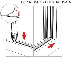
Rimuovere la pellicola protettiva del biadesivo dalla guida inferiore, applicare a pavimento la guida tra i due profili laterali. **Applicare la guida in battuta** sul lato opposto al cassonetto.
