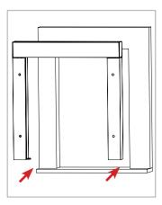
Posizionare il telaio e predisporre il fissaggio.
