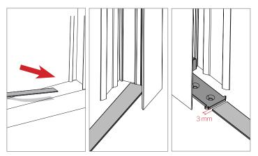
Rimuovere la pellicola protettiva del biadesivo dalla guida inferiore, applicare a pavimento la guida tra i due profili laterali. Applicare la guida in battuta lasciando un margine di 3 mm dall'aggancio inferiore.
