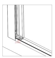
Fissare l'aggancio sulla guida lasciando un margine di 3 mm dalla guida. . L'aggan-cio inferiore dovrà essere fissato con il biadesivo.
