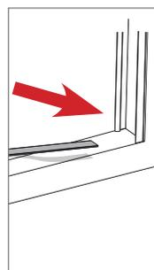
**12** Rimuovere la pellicola protettiva del biadesivo dalla guida inferiore, applicare a pavimento la guida tra i due profili laterali. **Applicare la guida in battuta lasciando un margine di 3 mm dall'aggancio inferiore.**
