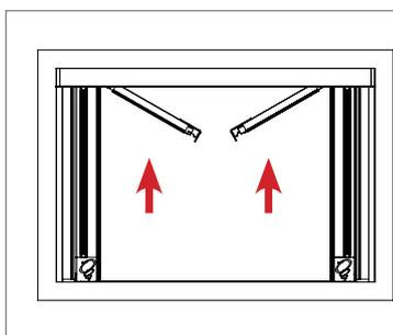
**14** Inserire il profilo con la catena all'interno della guida superiore, esercitando una pressione verso l'alto, partendo dal punto più vicino al profilo scorrevole. **ATTENZIONE: Il sistema è nella posizione corretta se si trova al di sopra dello spazzolino della guida superiore.**
