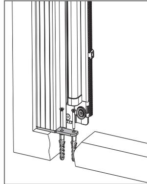
**3** Fissare la testata inferiore.
