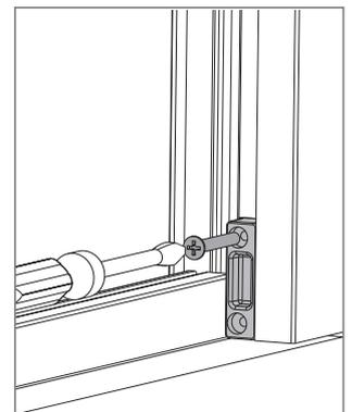
**12** Bloccare la guida inferiore e avvitare il fermo guida.
