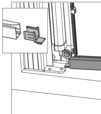
**10** Inserire l'aggancio nella guida inferiore e posizionare la guida facendola agganciare alla testata inferiore.
