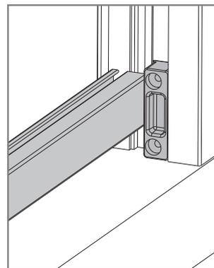
**11** Terminare il posizionamento della guida bassa, facendola scivolare sull'aggancio laterale.
