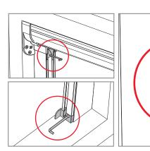
10 Regolare il posizionamento delle guide con un chiavino facendo attenzione a tenere le guide il più vicino possibile alla barra maniglia.
