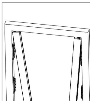
**8** Inserire i profili di riscontro sotto la guida inferiore e farli aderire alla parete laterale, scivolando delicatamente lungo la guida inferiore, facendo pressione sulle clips di aggancio.
