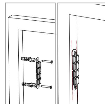
**7** Far aderire i profili laterali alle pareti al fine di tracciare la loro esatta collocazione sulla parete, applicando un segno con la matita. Applicare le clips di fissaggio (si raccomanda l'utilizzo delle clips quando l'altezza supera i 160 cm).
