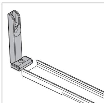
**4** Inserire gli attacchi a baionetta nella guida inferiore da entrambi i lati, facendo in modo che aderiscano perfettamente al muro.
