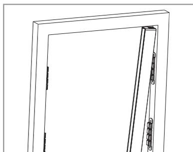
**8** Posizionare il profilo di riscontro sotto la guida inferiore e farlo aderire alla parete laterale, scivolando delicatamente lungo la guida inferiore. Agganciare il profilo alle clips facendo una leggera pressione.
