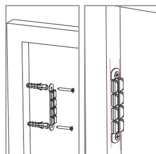
**7** Far aderire i profili laterali alle pareti al fine di tracciare la loro esatta collocazione sulla parete, applicando un segno con la matita. Fissare le clips (si raccomanda l'utilizzo delle clips quando l'altezza supera i 160 cm).
