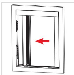
**10** Posizionare il profilo laterale con la barramaniglia, facendo pressione sulle clips di fissaggio e **agganciare la barramaniglia alla guida inferiore facendo una leggera pressione verso il basso, fino a che non si sente un click**. Controllare che la barramaniglia si sia agganciata correttamente.
