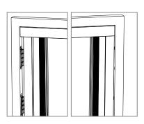
9 Applicare il profilo laterale con la barra maniglia. facendo pressione sulle clips di fissaggio.
