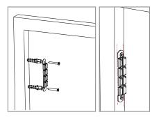
7 Far aderire i profili laterali alle pareti al fine di tracciare la loro esatta collocazione sulla parete, applicando un segno con la matita. Applicare le clips di fissaggio (si raccomanda l'utilizzo delle clips quando l'altezza supera i 160 cm).
