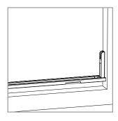
Applicare la guida inferiore completa di attacchi a baionetta al pavimento, servendosi del biadesivo.
