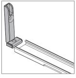
Inserire gli attacchi a baionetta nella guida inferiore da entrambi i lati, facendo in modo che aderiscano perfettamente al muro
